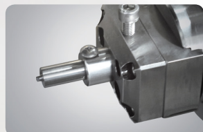
Зафиксировать заготовку в холдере, установить в фрезерный станок
